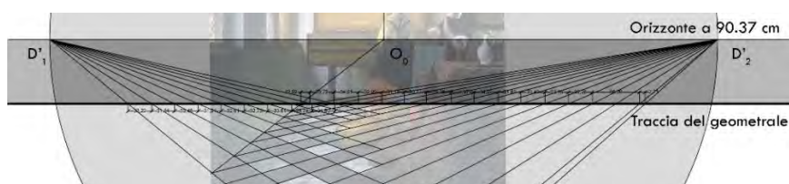
Fig. 6 - Restituzione prospettica delle fasce di mattoni che costituiscono la pavimentazione. Al di sotto della traccia del geometricale le distanze per le rette in fuga in D'_1 . Sopra la traccia gli intervalli tra le rette in fuga in D'_2 .
