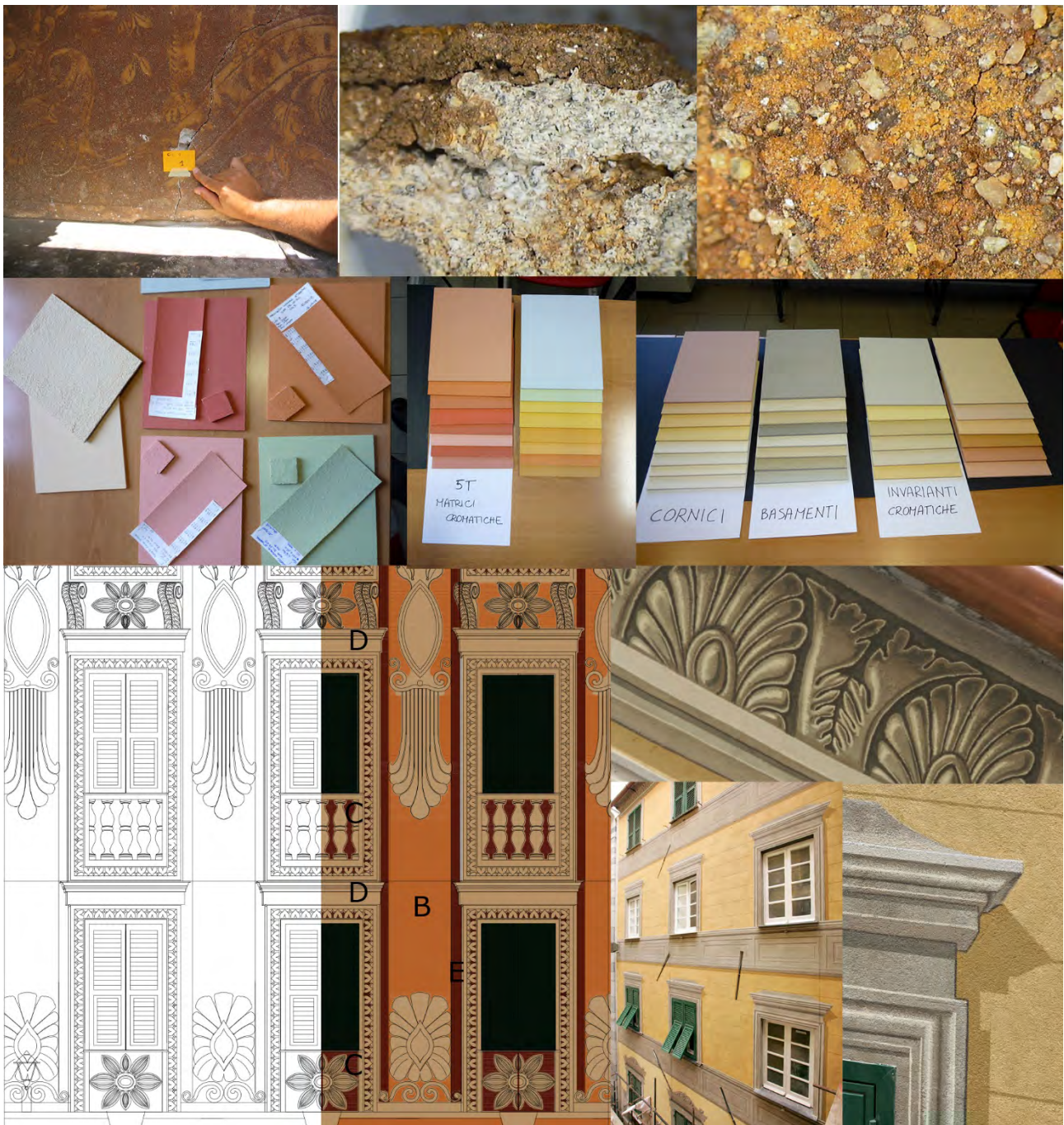
Fig. 1 – Dall' alto verso destra - Esempio di campionatura di intonaco per le successive indagini stratigrafiche di laboratorio, n.2 sezioni del campione visto a microscopio; n.3 immagini di riproduzione in prodotto verniciante delle tinte originali locali e stesura su supporti avente differente granulometria; rappresentazione dell'apparato decorativo di facciata e delle scelte cromatiche progettuali; Facciate dipinte recuperate.
