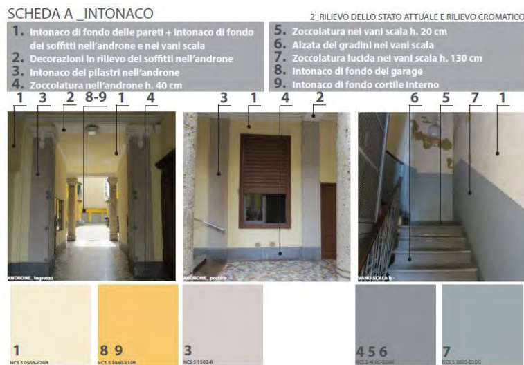
Fig. 3 – Scheda tecnica di rilievo cromatico degli intonaci, utilizzando il sistema NCS.
