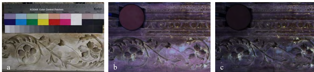
Fig. 1 - Documentazione fotografica su porzione del fregio floreale ripreso in: a) luce visibile con riferimento Kodak Color Control Patches e Gray Scale ; b) luminescenza ultravioletta con piastrina di solfato di bario, c) luminescenza ultravioletta postelaborata.
